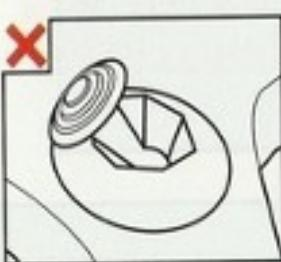
この時に、3Dスティックが傾いている場合(左上の図)、傾いた状態が「ニュートラルポジション」と設定されます。このようにニュートラルポジションの位置がズれた状態では、3Dスティックが正常に操作できなくなります。
